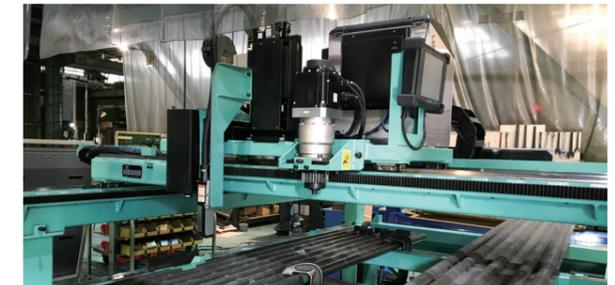
■3D位置検出マーキング切断溶接開先加工
