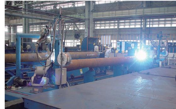
■パイプフランジロボット溶接システム
